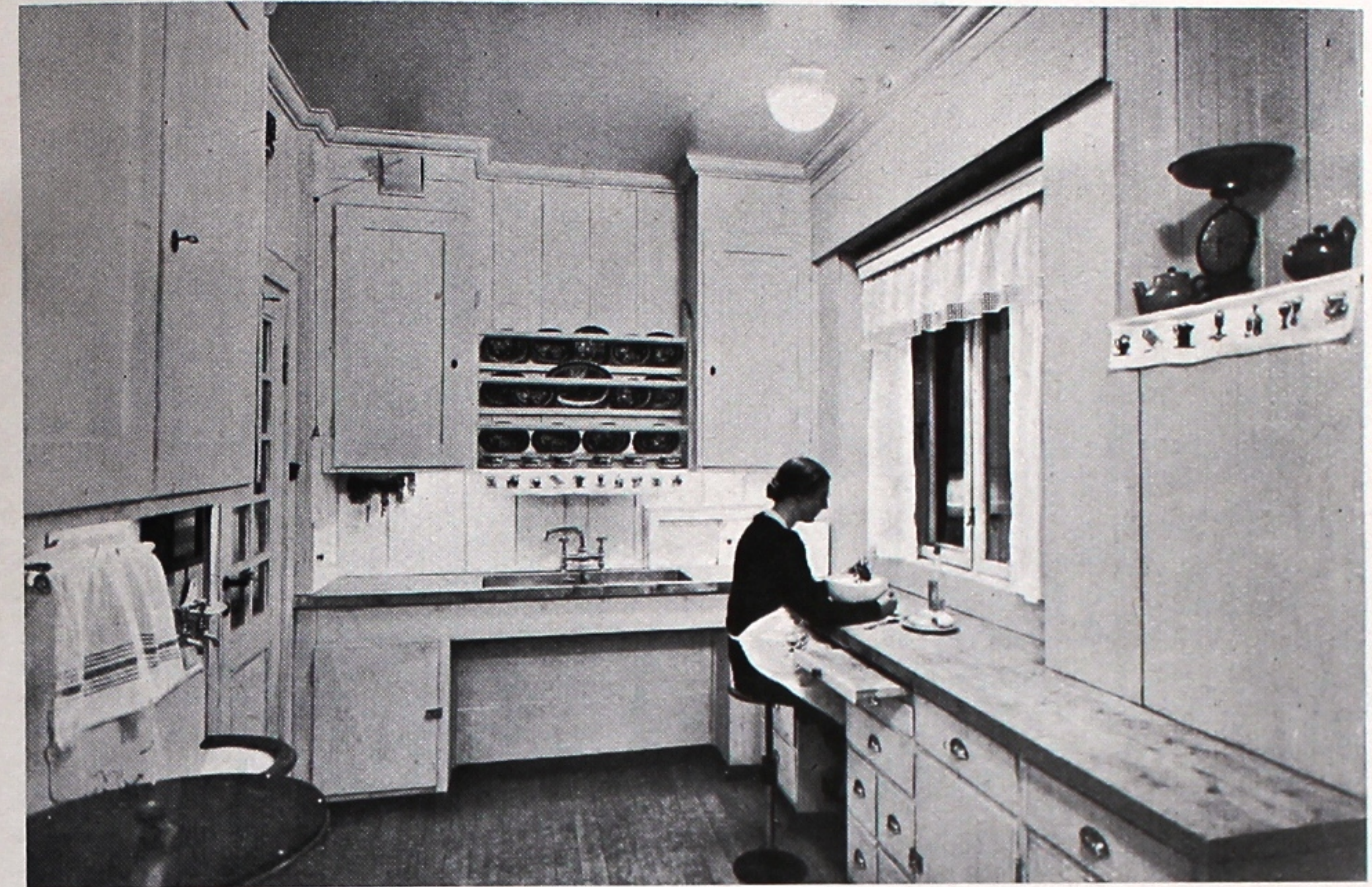
STÖRRE KÖK MED FLERA TAKARMATURER, ORIENTERADE EFTER ARBETSPLATSERNA. TILLSATSBELYSNING UNDER SKÅPHYLLORNA
