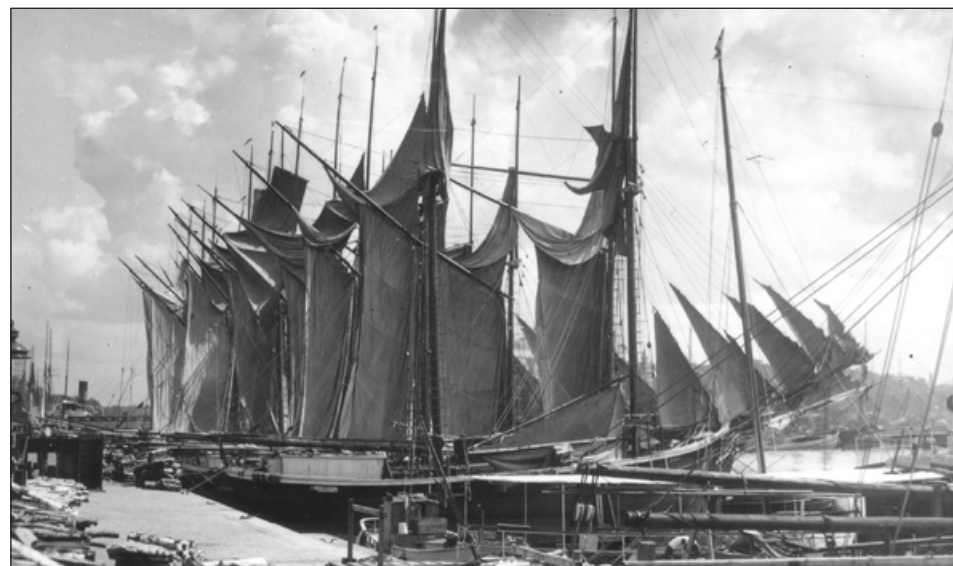
Vedskutor med segel på tork utmed Strandvägskajen på 1920-talet. Roslagsskutorna ligger förtöjda med aktern mot kajen för att underlätta lossningen av ved. Foto K. Wallberg. SSM.
