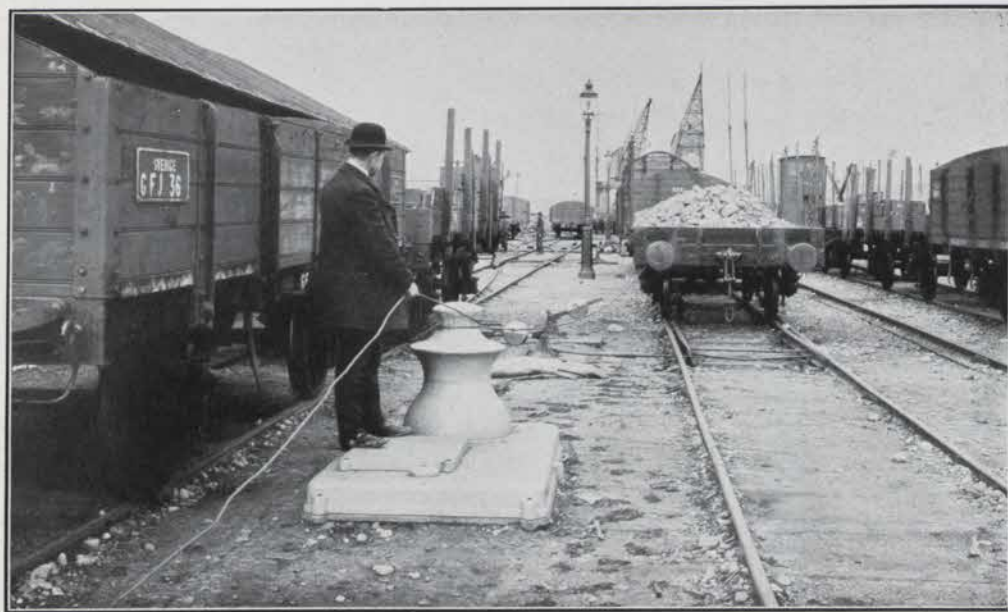
ELEKTRISKA FÖRHÄLNINGSSPEL VID MALMLASTNINGSKAJEN.
