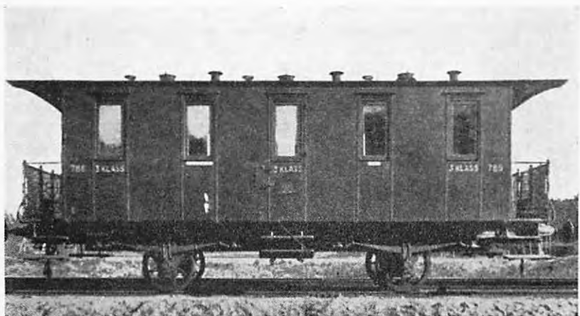
S.J:s personvagn av 1884 års modell, III klass. Dessa vagnar hade plattformar och gaveldörrar men endast en sidodörr i vardera långsidan.
