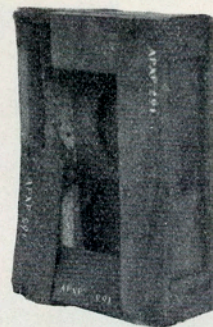
Avvägningspegel av [Elwings modell, t. v. den å Vitön funna, t. h. genomskärning av samma modell som den funna.
